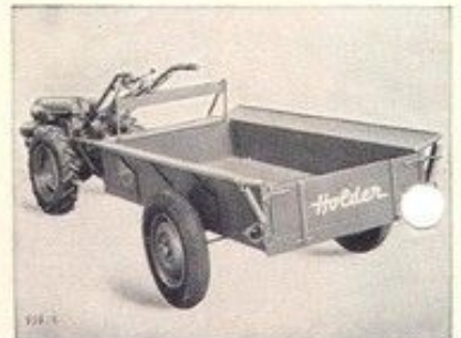
HOLDER-Einachs-Anhängewagen Tragkraft 22 Ztr.
