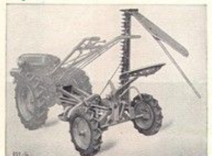
HOLDER-Seiten-Mähwerk Arbeitsbreite 1,2 m
